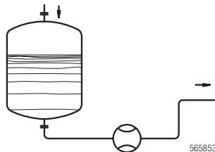
Le système de conduites doit assurer que le compteur soit rempli de liquide en permanence et qu'aucune inclusion d'air/gaz ne puisse avoir lieu en mode de fonctionnement. Le compteur doit enregistrer les quantités consommées par tous les utilisateurs.
