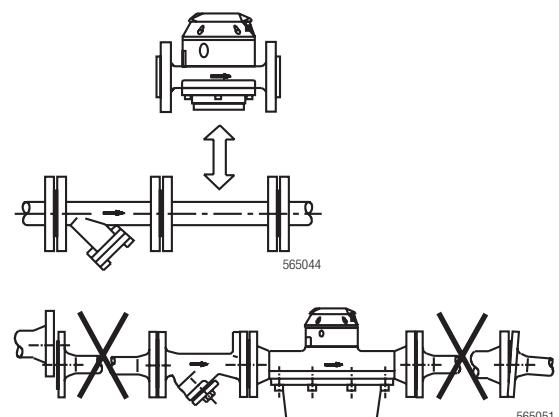
Bei ARD 4XXX (Kunststoffausführung) Anzugsdrehmoment für die Flansch-Schrauben einhalten:
