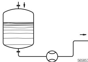
Die Rohrleitungsführung muss sicherstellen, dass das Messgerät im Betriebszustand jeder Zeit mit Flüssigkeit gefüllt ist und keine Luft- und Gaseinschlüsse auftreten. Alle Bezüge sind vom Messgerät zu erfassen.
